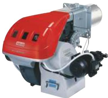
Серия горелок RLS/M MX мощностью от 350 до 1840 кВт разработана для использования в котлах горячей воды низкой или средней температуры, генераторах горячего воздуха или пара, котлах с маслом-теплоносителем. На стороне жидкого топлива используется двухступенчатый режим, а на стороне газа — модуляционный режим при установке ПИД- регулятора и необходимых датчиков.
